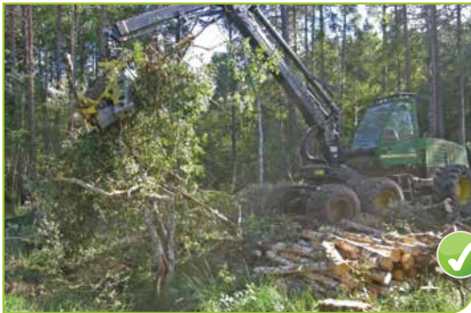
Mise en place d'un tapis de rémanents* pour éviter l'orniérage et l'érosion des sols
