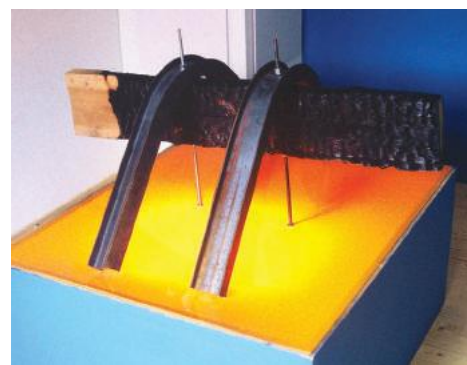
Des essais sont régulièrement réalisés pour observer la réaction du bois et des pièces métalliques en cas d'incendie.
