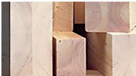
C'est un matériau constitué d'un assemblage de 2 à 5 lames de bois massif de fortes épaisseurs (plus de 45 mm et moins de 80 mm), collées face contre face dans le sens des fibres. On le désigne aussi par Duo-Trio ou encore contrecollé.
