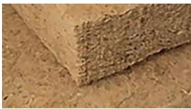
Matériau isolant, naturel et écologique, le bois fibre permet de réaliser des panneaux de fibre de bois dont les qualités acoustiques et thermiques sont de plus en plus recherchées dans l'ameublement et les constructions bois, de plus ils sont entièrement recyclables.
